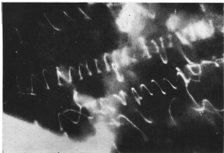
Фото 1. Микрофотография декорированных геликоидальных дислокаций в NaCl (Амелинке и др. [1]).
