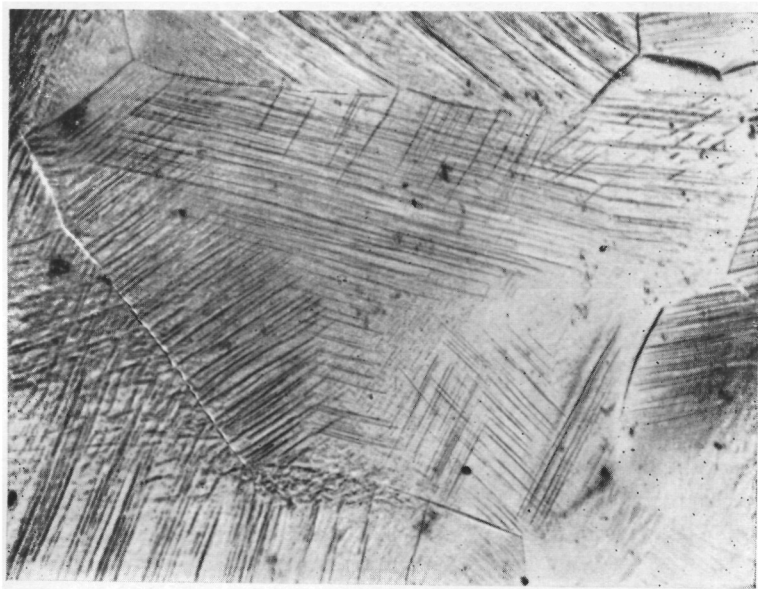
Фото 23. Линии скольжения в поликристаллическом образце алюминия высокой чистоты, растянутом на несколько процентов (Боас и Огилви [7]).
